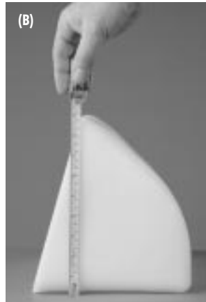
(B) With bucket back laid flat, measure the horizontal projection of the bucket (B). Avec godet posé à plat, mesurer la projection horizontale du godet (B).
