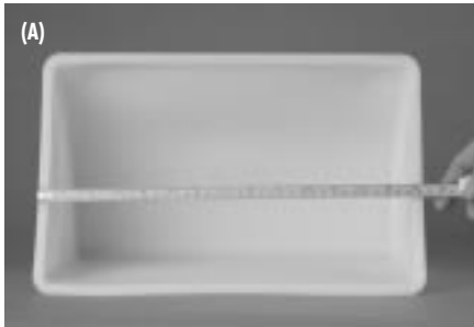
(A) With bucket back laid flat, measure overall length (A). Avec godet posé à plat, mesurer la largeur hors tout (A).
